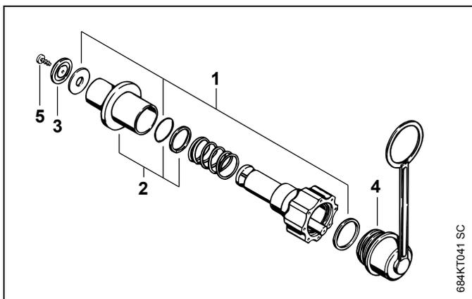
**Einfüllsystem für Kraftstoff (C)** **0000 890 5001**
