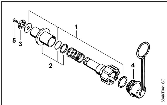
**Einfüllsystem für Kraftstoff (C)** **0000 890 5000**
