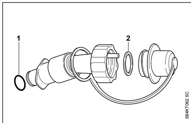
**Einfüllsystem für Kettenhaftöl** **0000 890 5004**
